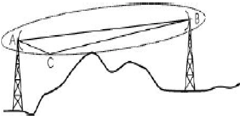
Σχήμα 9.18 Σχεδίαση ραδιοζεύξης έτσι ώστε τα εμπόδια να βρίσκονται εκτός της 1 ης ζώνης Fresnel.
