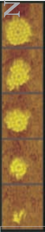
Μια νησίδα πυριτίου πάνω σε κρύσταλλο πυριτίου διαλύεται αργά στους 450 βαθμούς. Η γνώση των διεργασιών αυτών έχει σημασία για την ποιότητα των λεπτών στιβάδων.
