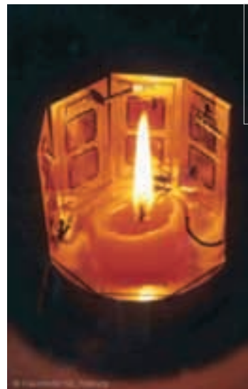
Το φως του κεριού αρκεί στα θερμοφωτοβολταϊκά συστήματα για να τροφοδοτήσουν ένα ραδιόφωνο.
