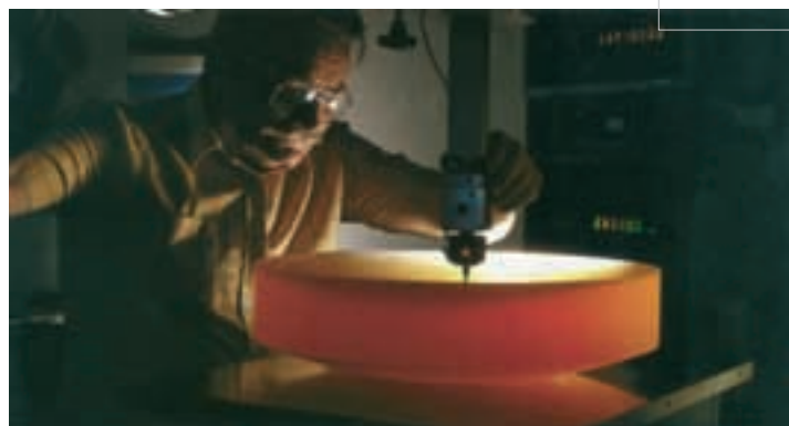
Το ειδικό κεραμικό Zerodur για μάσκες λιθογραφίας το οποίο διατηρεί αμετάβλητο το σχήμα του ακόμα και σε νανοκλίμακα.
