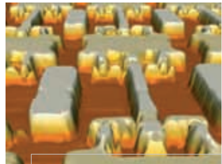
Με «χωρητικούς» ανιχνευτές είναι δυνατόν να απεικονιστούν επίσης οι διαδικασίες μεταγωγής σε ηλεκτρονικό ολοκληρωμένο κύκλωμα (τσιπ).
