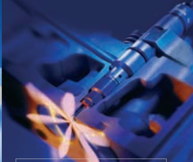
Ακροφύσιο ανάφλεξης πετρελαιοκίνητων οχημάτων. Τα μελλοντικά συστήματα θα διαθέτουν προστατευτικά επιστρώματα με δομή αδάμαντα πάχους μερικών δεκάδων νανομέτρων.
