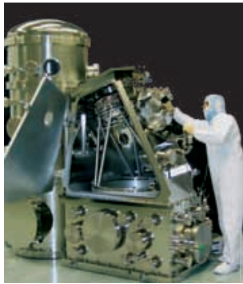
Πρωτότυπο εγκατάστασης βιομηχανικού αποτυπωτή EUV για την παραγωγή τσιπ μελλοντικών γενεών.
