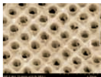
Πομπός βολφραμίου με νανοδομημένη επιφάνεια για την προσαρμογή του φάσματος υπερύθρου.
