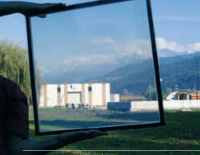
Διπλός υαλοπίνακας με διάκενο από θερμομονωτικό πήκτωμα.
