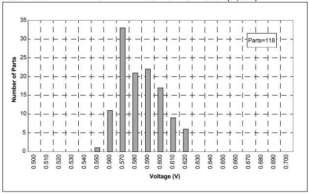
FIGURE 18-52: TYPICAL VP6 REFERENCE VOLTAGE DISTRIBUTION (5V, 125°C)
