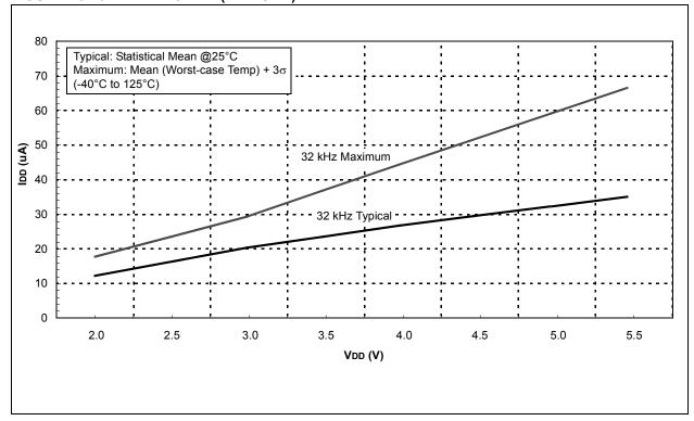
FIGURE 18-11: TYPICAL IDD vs. FOSC OVER VDD (HFINTOSC MODE)
