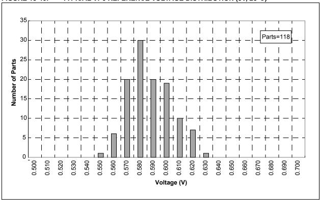
FIGURE 18-47: TYPICAL VP6 REFERENCE VOLTAGE DISTRIBUTION (3V, 85°C)
